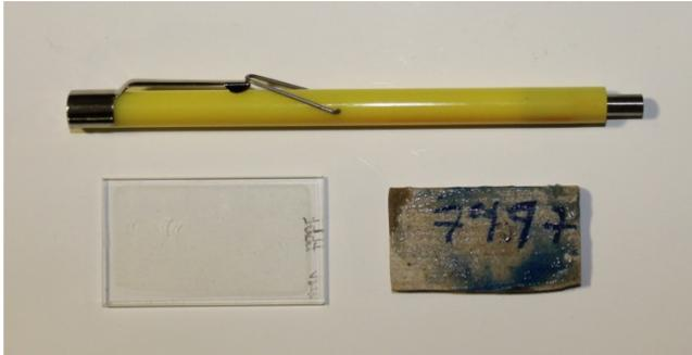
Abb. 2: Dünnschliff der zu untersuchenden Gesteinsprobe. (Magnetstift = 12,5 cm)
